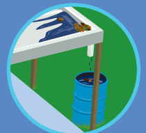
Azotea plana sin adecuado drenaje
